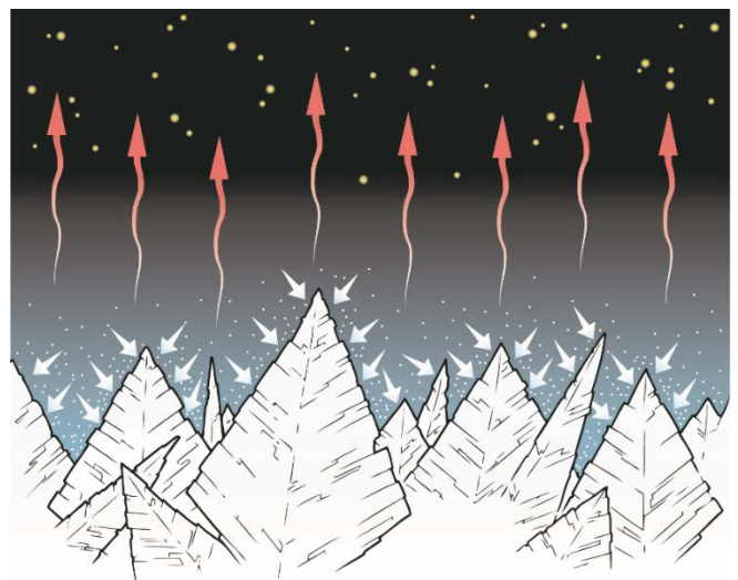
Figur 9: Overflaterim dannes optimalt under kalde skyfrie forhold med svak vind ( \sim 1-3 m/s).
